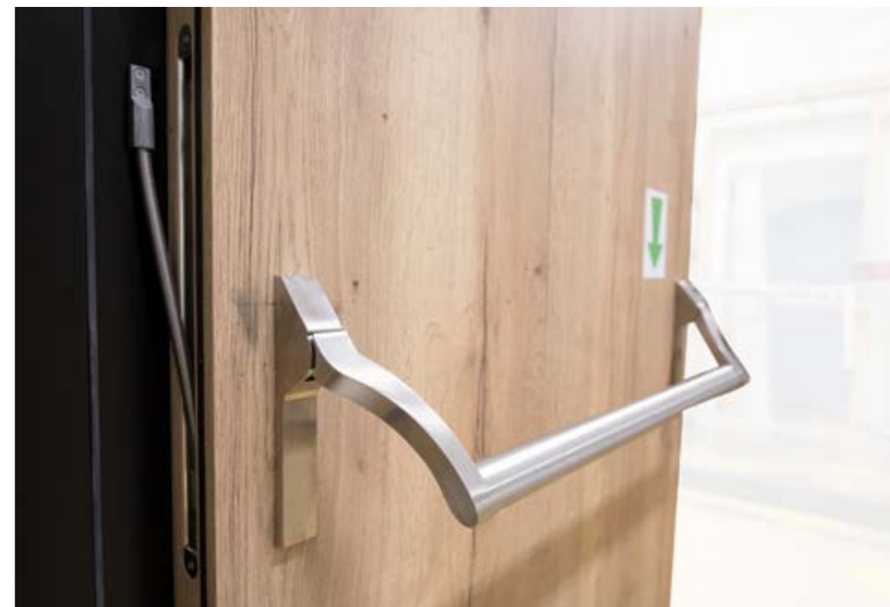
Pouze dveře SECURO dokáží nabídnout jednostranně kontrolovaný vstup v kombinaci s únikem dle EN 1125. Proud pro elektromechanický zámek je veden skrze kabelovou průchodku a konstrukci křídla.
